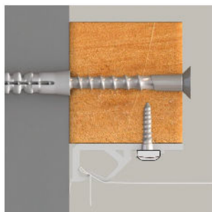
fig. 02 : Pose avec tasseau bois
