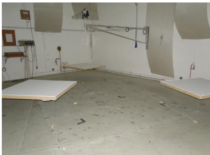
Dispositions des 3 baffles dans la salle d'essais
