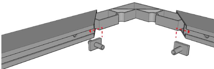
1. Insérer l'équerre dans les profilés et les écrous dans la rainure.
