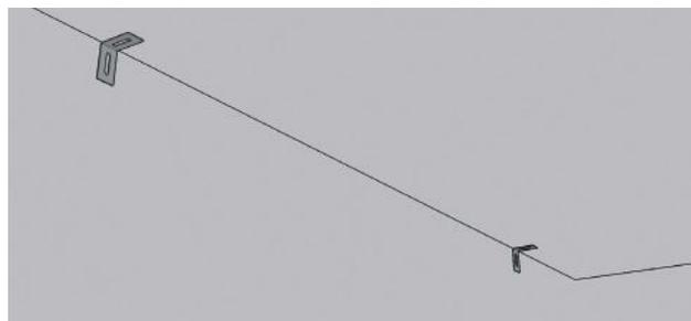
**2.** Positionner 2 équerres de maintien par profilé (3 si longueur > 3 mètres).
