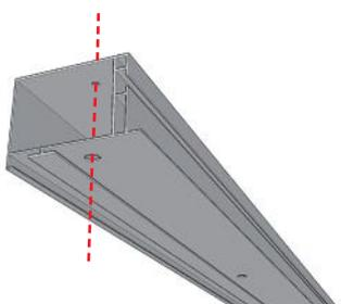
**3.** Prépercer le profilé tous les 1,50m (percer suffisamment large pour permettre le passage de l'outil de serrage).
