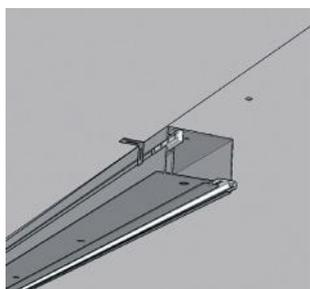
**5.** Positionner le profilé sur le support afin de reporter et tracer les pré-perçages.
