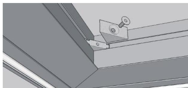
**8.** Mettre en place le kit equerre d'assemblage dans la gorge intérieure.
