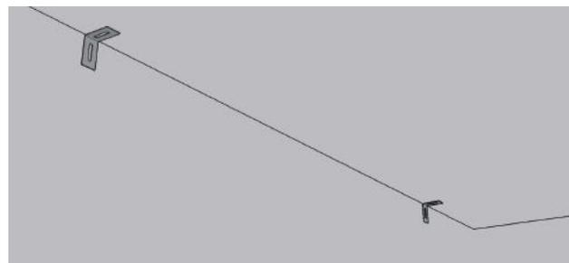
**2.** Positionner deux équerres de maintien par profilé (3 si longueur > 3 mètres).
