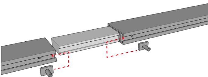
1. Insérer le raccord dans les profilés, insérer les écrous dans les rainures.
