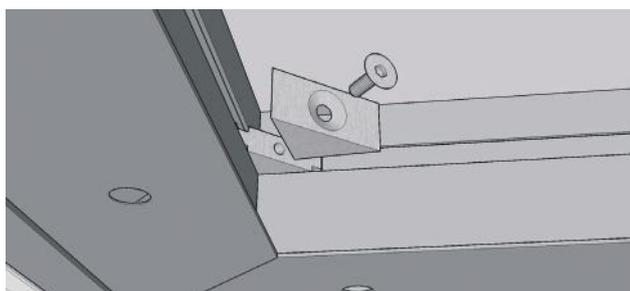
**9.** Mettre en place le kit équerre d'assemblage dans la gorge intérieure.
