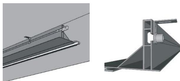
**4.** Positionner le profilé sur les équerres avec vis et écrou cage.
